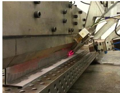
Le soudage hybride repose sur l'utilisation simultanée d'une tête laser et d'une torche de soudage à l'arc. L'une projette un faisceau pour fusionner deux pièces ; l'autre complète l'action en déposant simultanément du métal d'apport, réalisant ainsi un cordon. Ce mariage permet de cumuler les avantages issus des deux techniques. Tout d'abord la rapidité ; les rendements sont ceux du soudage laser et permettent des vitesses d'exécution 10 fois supérieures au soudage à l'arc traditionnel.
