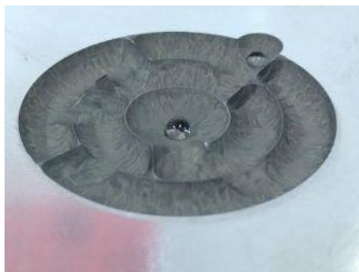
Texturation superhydrophobe sur pièce 3D Inox
