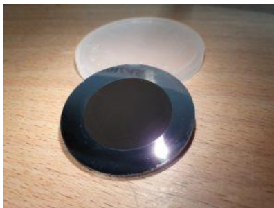
Texturation noire mat sur Inox (Réflexion dans le visible < 2%)
