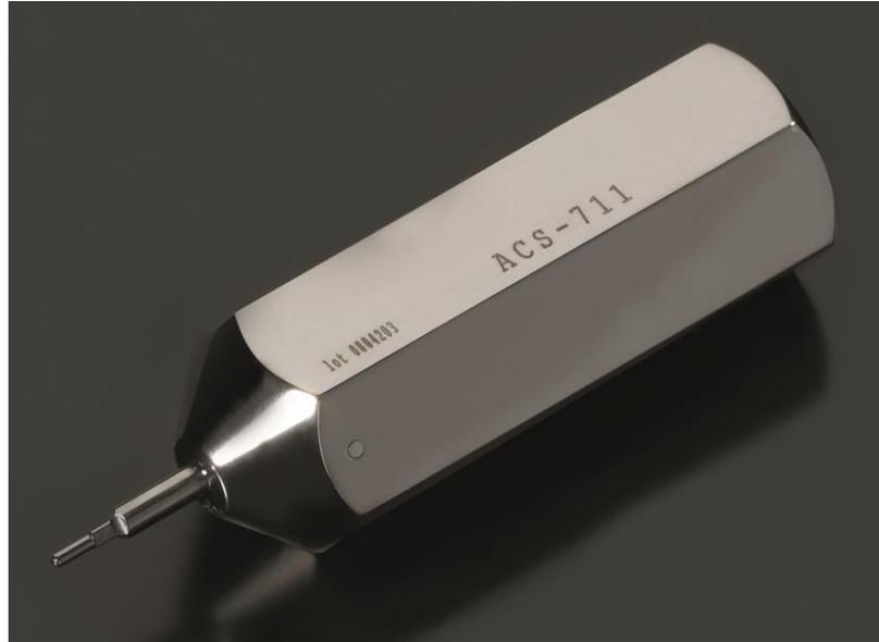
Le marquage est majoritairement superficiel (quelques centièmes). Il permet de réaliser un décor, une identification pour la traçabilité (QR code, numéro de lot...) etc... . L'action du laser en surface reste « limitée ».
