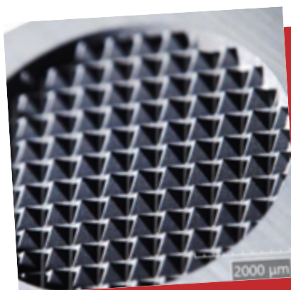
Micro-cavités pyramidales usinées par laser USP
